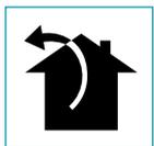
In questa versione, fumi e vapori vengono convogliati verso l'esterno attraverso il tubo di scarico. A tal fine, il raccordo d'uscita della cappa, deve essere collegato tramite un tubo, ad un'uscita esterna.
